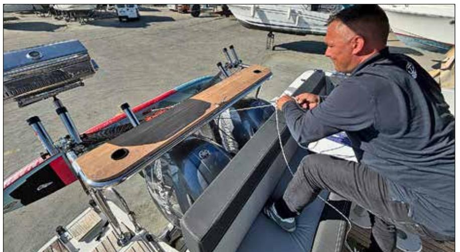
Un système de palan permet de remonter les paddles ou les annexes et de les plaquer contre l'Annexotech.
