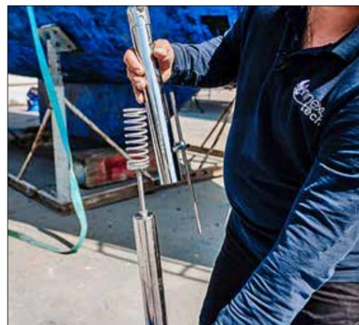
Les montants sont équipés de ressorts dont la tension s'adapte aux réglages de l'Annexotech.
