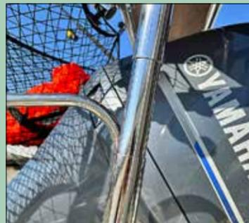
Les montants latéraux sont montés sur ressorts pour permettre une certaine souplesse.
