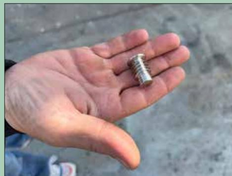
Pour fixer les platines dans le tableau arrière, le plaisancier a le choix entre des inserts (photo) et un boulonnage classique.
